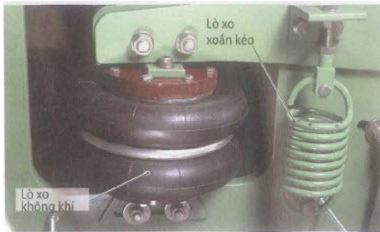
Hình 1: lò xo không khí & lò xo xoắn kéo trong máy dệt vải
